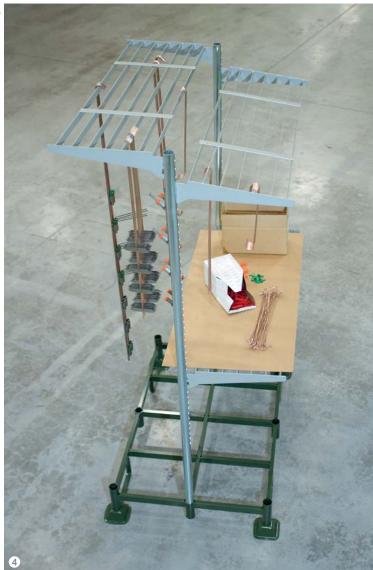
Figura 4: Il carrello può essere utilizzato sia come piano di lavoro per la preparazione dei materiali sia per la mascheratura.
