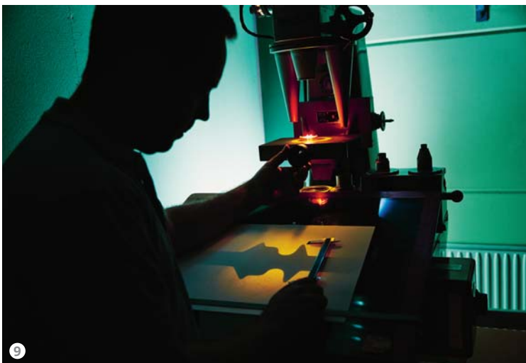
Figura 9: Nei test di controllo di un tappo si verificano l'adeguata configurazione, il peso e le misure costanti degli stampi.
