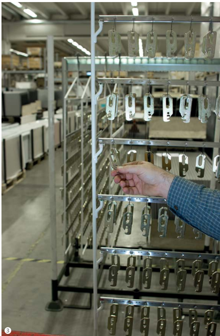
Figura 3: Il telaio offre la possibilità di sganciare i pezzi con la dovuta cautela e attenzione.
